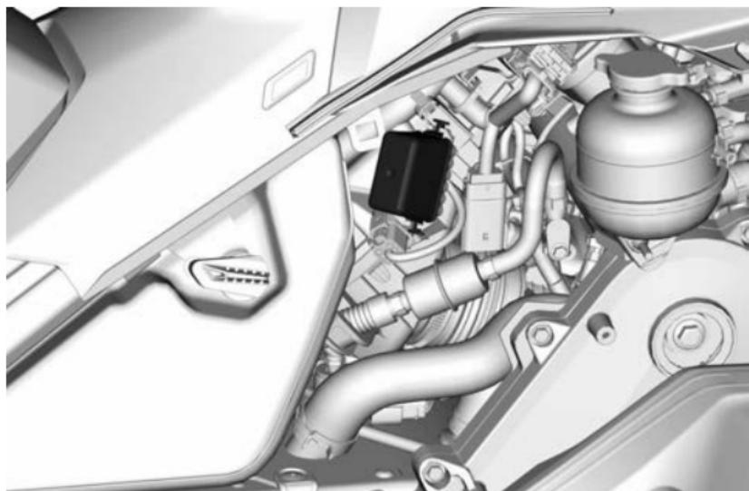
**МОНТАЖНЫЙ БЛОК ПРЕДОХРАНИТЕЛЕЙ**
