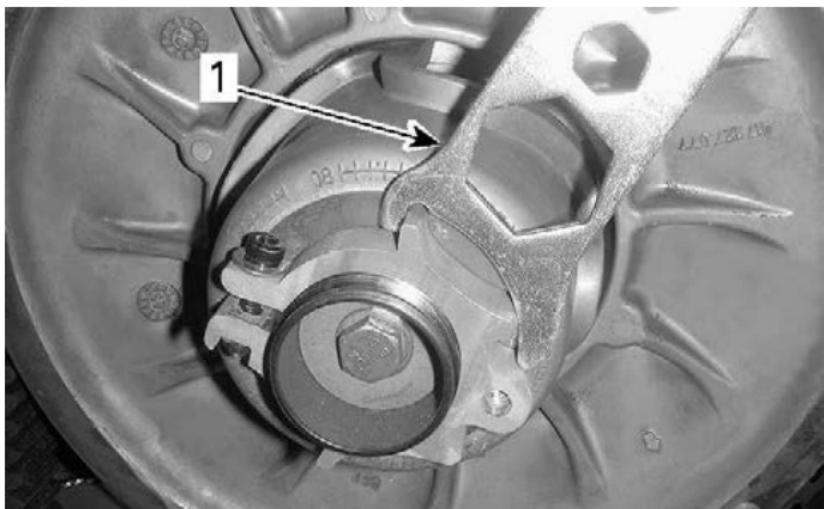
1. Приспособление для регулировки
