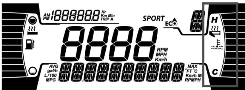
**ИНДИКАЦИЯ ОБОГРЕВА РЫЧАГА ДРОССЕЛЬНОЙ ЗАСЛОНКИ**
