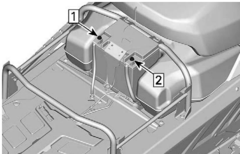
1. Отсоедините отрицательную клемму
