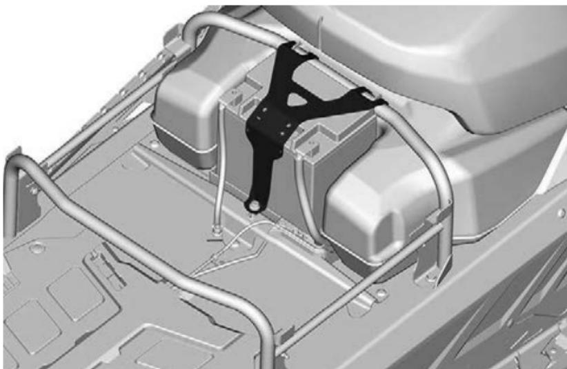
6. Снимите аккумуляторную батарею.
