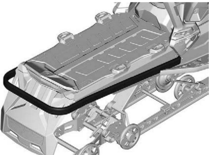
**ТИПОВОЙ ВАРИАНТ — СТАНДАРТНЫЙ БАМПЕР**
