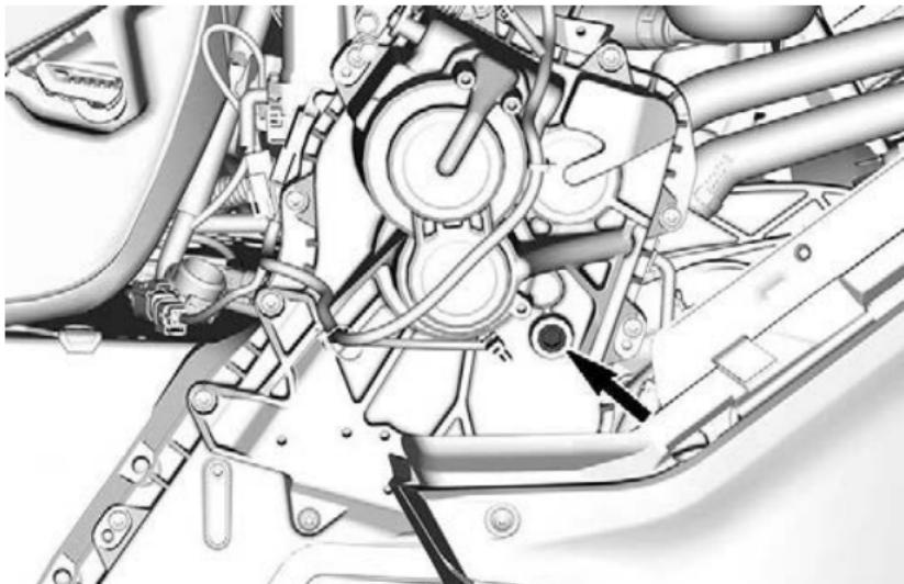
**ПРОБКА ЗАЛИВНОГО ОТВЕРСТИЯ**
