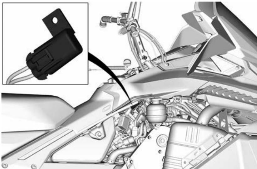
**ПЛАВКИЙ ПРЕДОХРАНИТЕЛЬ ВЕНТИЛЯТОРА РАДИАТОРА**
