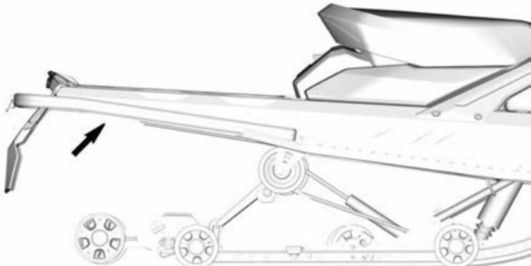
5. Во время регулировки тяните за трос масляного насоса до тех пор, пока отработавшие газы не примут вид более темного дыма.
