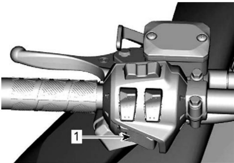
1. Кнопка запуска двигателя/включения электронного реверса
