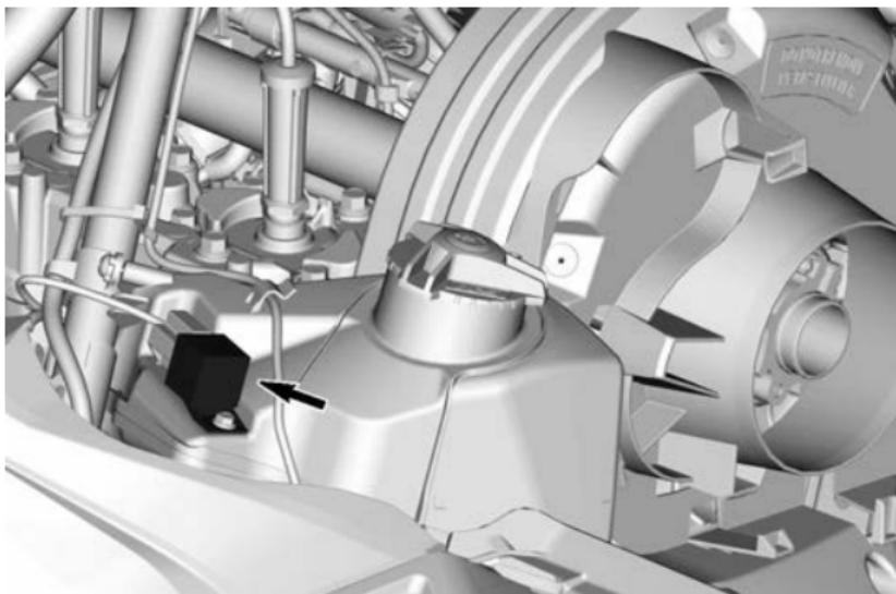
**РЕЛЕ ВЕНТИЛЯТОРА РАДИАТОРА**
