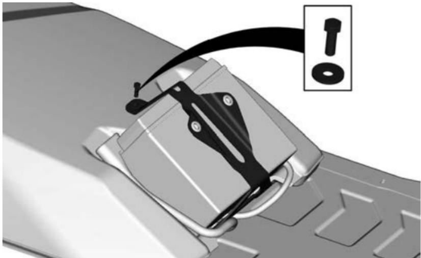
5. Снимите аккумуляторную батарею.
