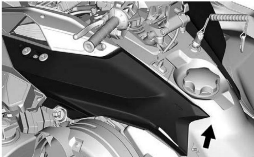
**12. Снимите верхнюю панель корпуса.**
