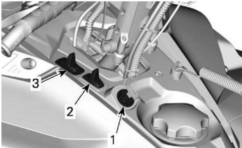
1. Переключатель запуска двигателя / включения электронного реверса
