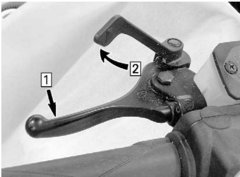
**ТИПОВОЙ ВАРИАНТ – ВКЛЮЧЕНИЕ СТОЯНОЧНОГО ТОРМОЗА**
