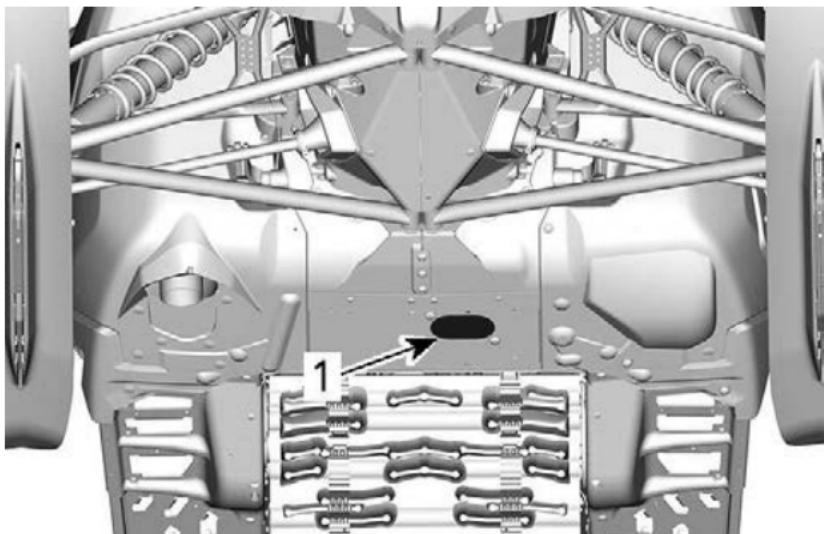
1. Крышка доступа сливных пробок
