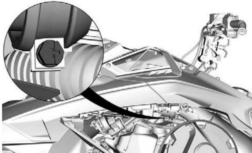
10. Выверните болты крепления верхнего модуля корпуса (капота) с обеих сторон.
