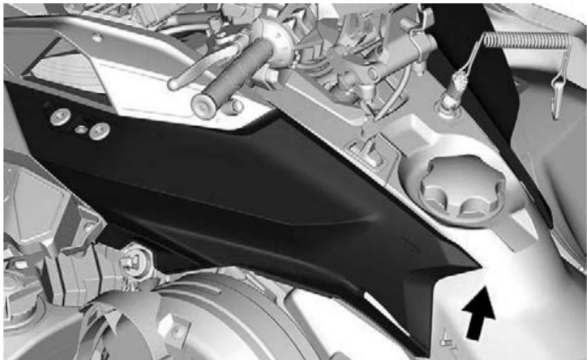
12. Снимите верхнюю панель корпуса.
