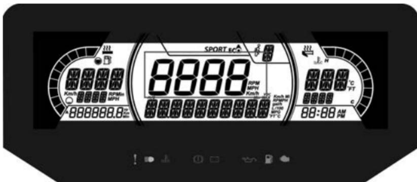
Отображение скорости транспортного средства в км/ч (или милях/ч) или частоты вращения двигателя в об/мин. См. раздел «Настройки».
