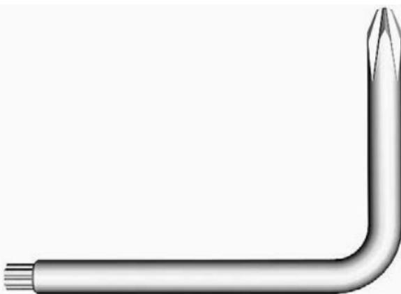
**ИНСТРУМЕНТ ДЛЯ РАЗВЕДЕНИЯ ШКИВА И РЕГУЛИРОВКИ
