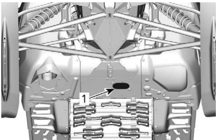
1. Крышка доступа сливных пробок
