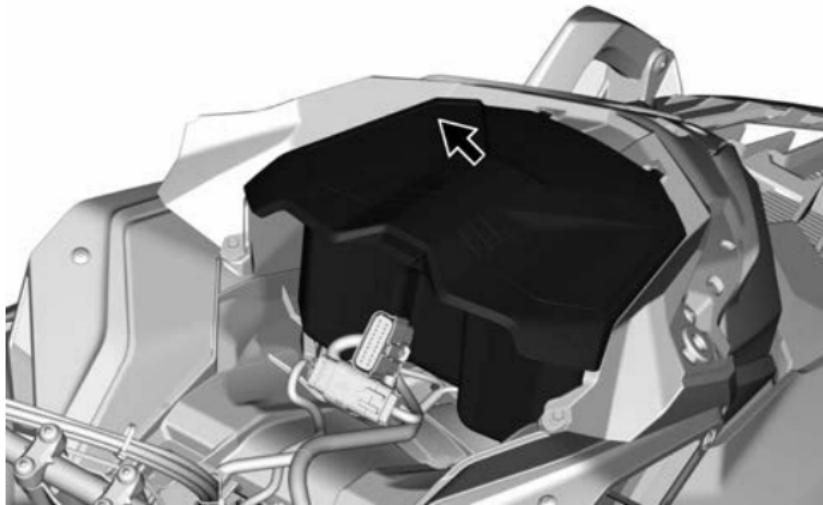
7. Отсоедините электрические разъемы фар и датчика давления и температуры во впускном коллекторе (MAPTS) (2-тактовый двигатель).
