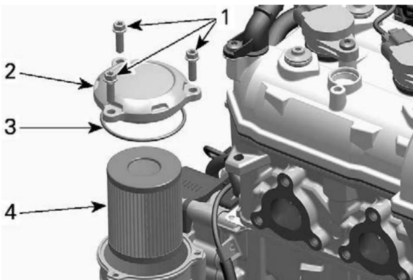
1. Винты крышки масляного фильтра
