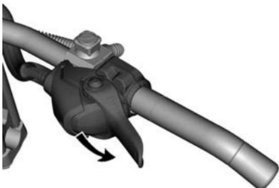
**ИЗМЕНЕНИЕ ПОЛОЖЕНИЯ РЫЧАГА ДРОССЕЛЬНОЙ ЗАСЛОНКИ: НАЖМИТЕ ВНИЗ, ЧТОБЫ ПОВЕРНУТЬ УЗЕЛ РЫЧАГА УПРАВЛЕНИЯ ДРОССЕЛЬНОЙ ЗАСЛОНКОЙ**
