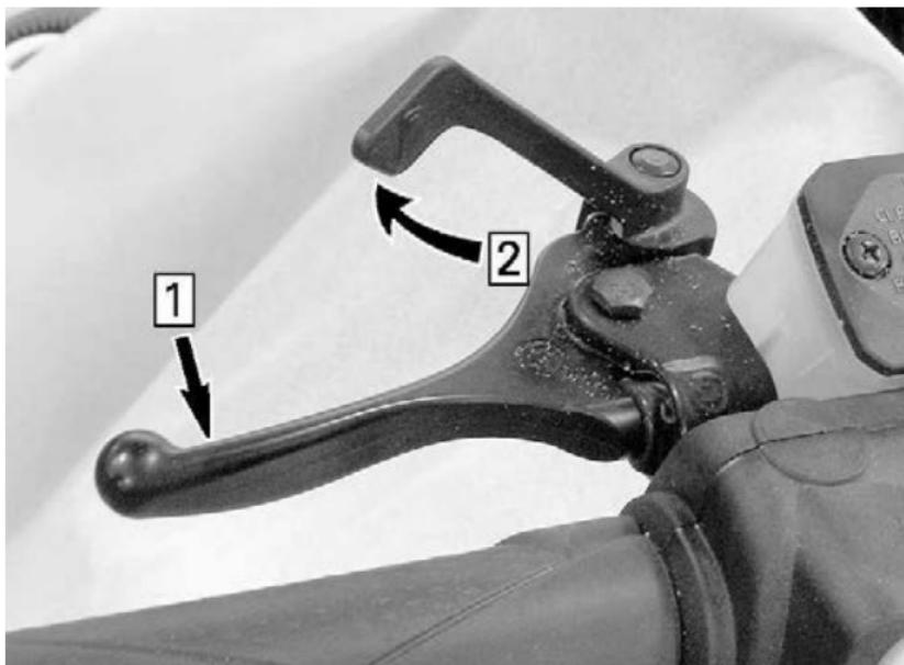
**ТИПОВОЙ ВАРИАНТ – ВКЛЮЧЕНИЕ СТОЯНОЧНОГО ТОРМОЗА**
