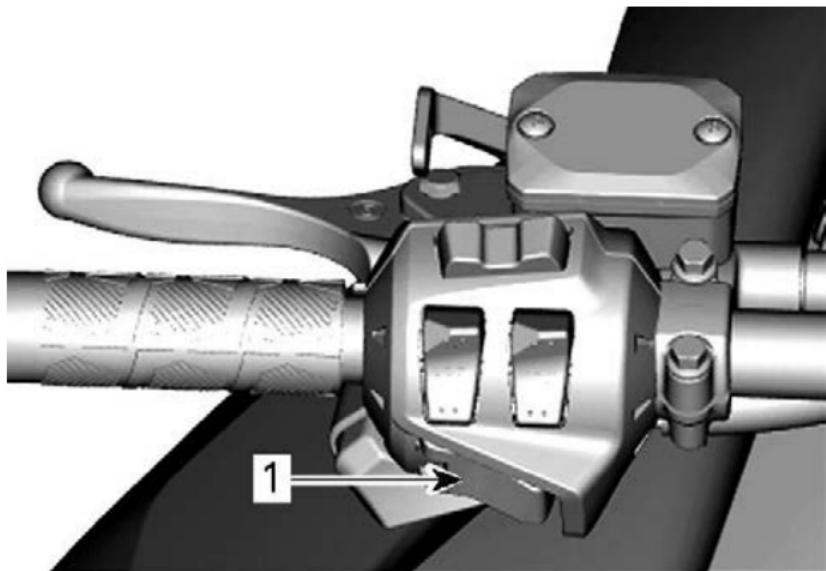
1. Кнопка запуска двигателя/включения электронного реверса
