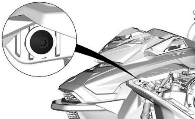
11. Поднимите заднюю часть бокового капота так, чтобы его лапки вышли из задней консоли.
