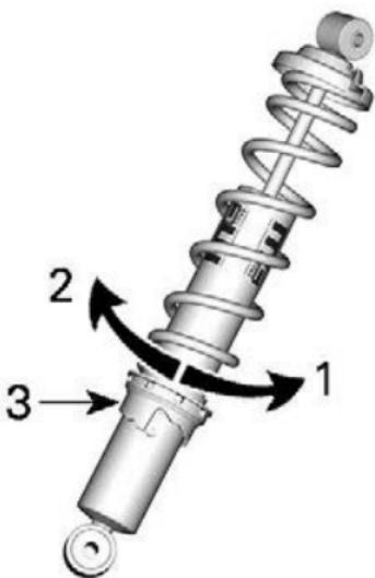
**РЕГУЛЯТОР КУЛАЧКОВОГО ТИПА — АМОРТИЗАТОР С РЕГУЛЯТОРОМ ДВИЖЕНИЯ**
