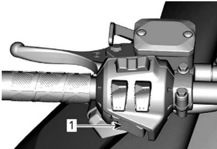
**1. Кнопка запуска двигателя/включения электронного реверса**
