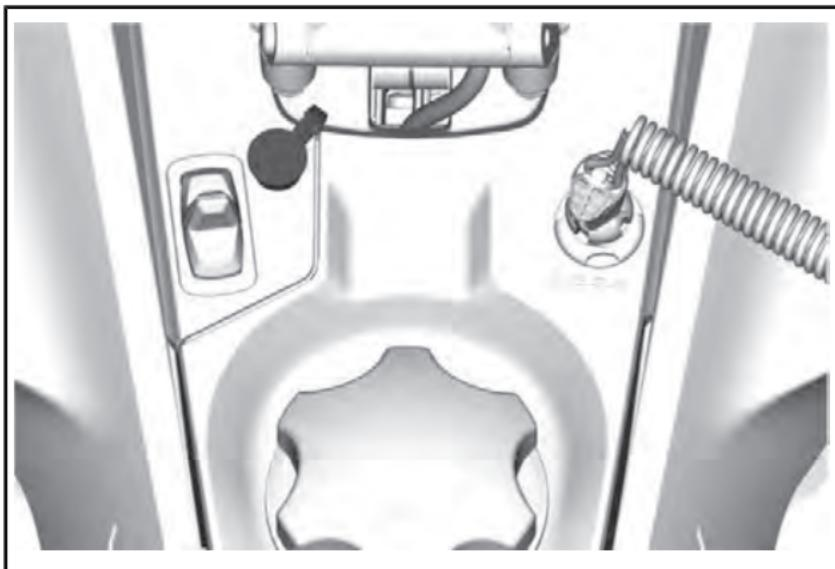
*ВОДИТЕЛЬ — РАСПОЛОЖЕНИЕ РАЗЪЕМА ДЛЯ ВИЗОРА С ОБОГРЕВОМ*
