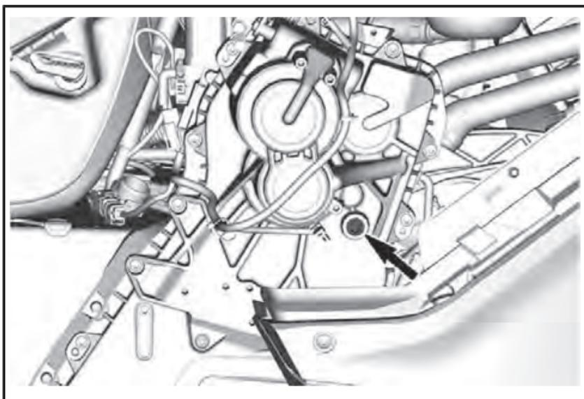
**ПРОБКА ЗАЛИВНОГО ОТВЕРСТИЯ**
