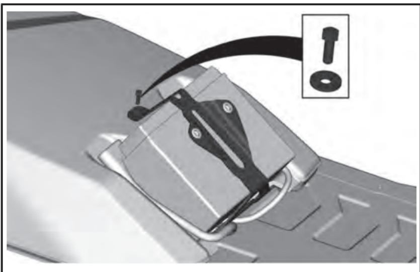
6. Снимите аккумуляторную батарею.
