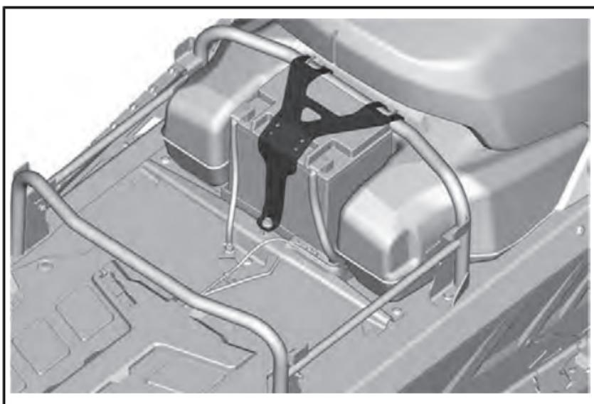
6. Снимите аккумуляторную батарею.
