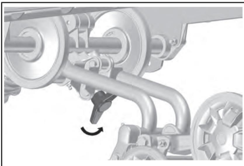
**ПОВЕРНТИТЕ РУКОЯТКУ ДО УПОРА ПРОТИВ ЧАСОВОЙ СТРЕЛКИ — БОЛЕЕ МЯГКАЯ ПОДВЕСКА**
