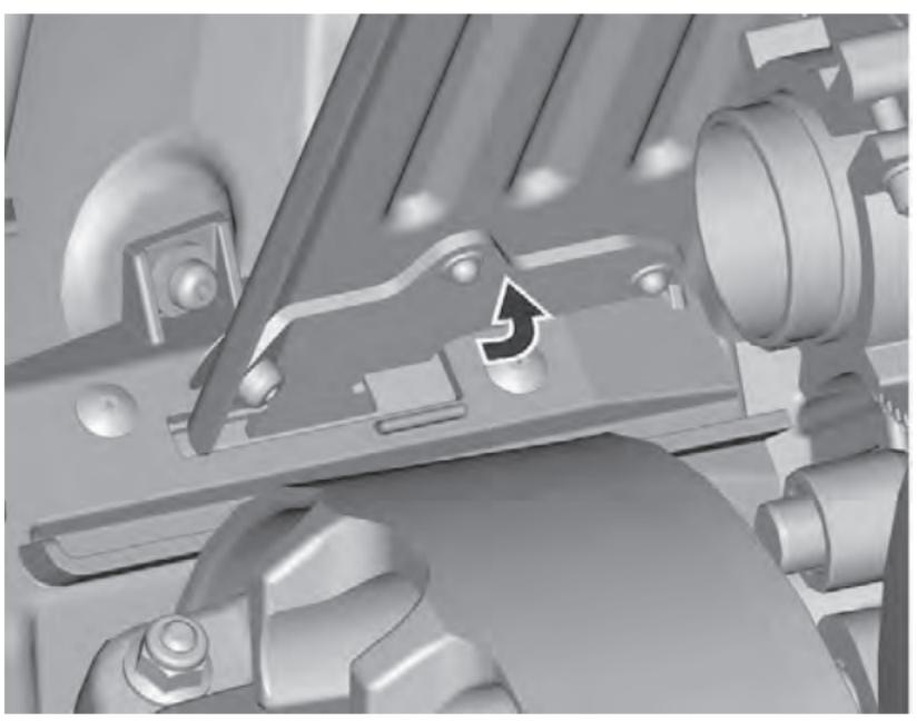
Установите заднюю часть кожуха на держатель и закрепите его с помощью проволочного фиксатора.
