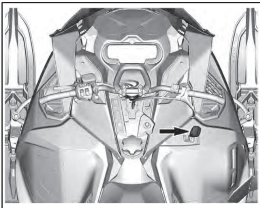
С помощью данного рычага осуществляется переключение передач. Коробка передач имеет две передачи переднего хода и нейтральную передачу.
