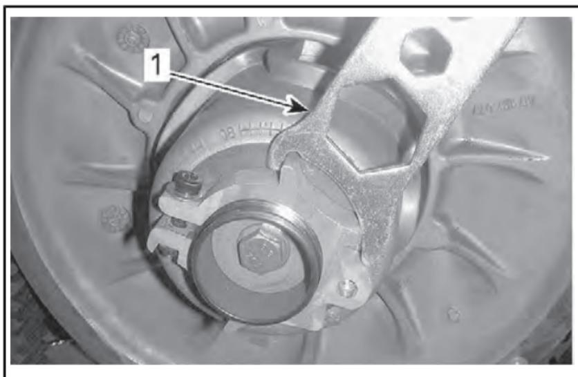
1. Приспособление для регулировки
