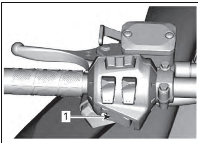
1. Кнопка запуска двигателя/включения электронного реверса
