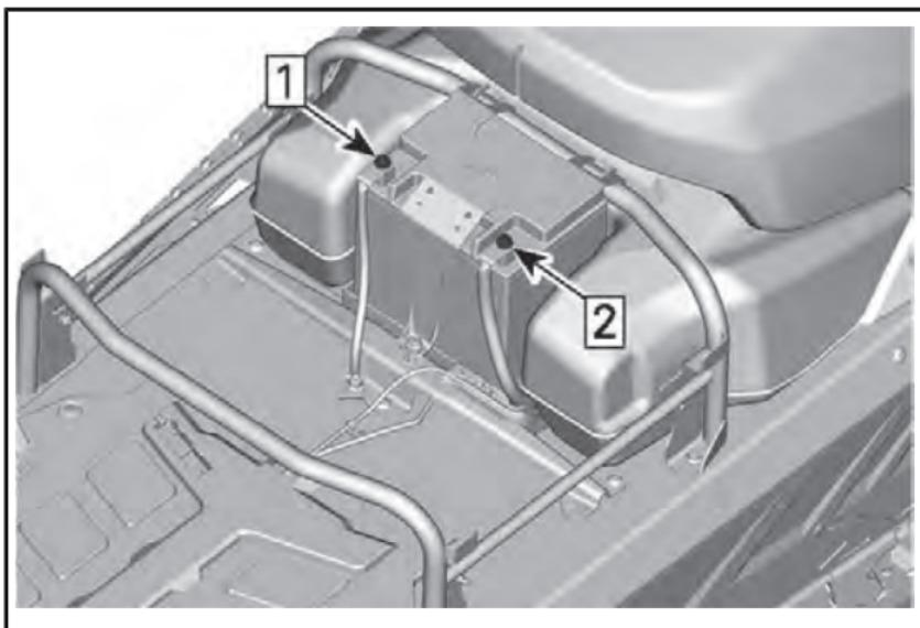
*Шаг 1: Отсоедините отрицательную клемму*
