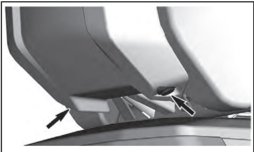
2. Снимите панель отделки, сдвинув ее вверх.
