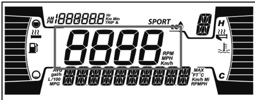
Отображение частоты вращения двигателя в об/мин или скорости транспортного средства в км/ч или милях/ч.
