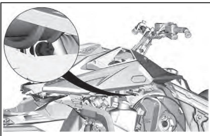
9. Выверните болты крепления верхнего элемента корпуса (капота) с обеих сторон.
