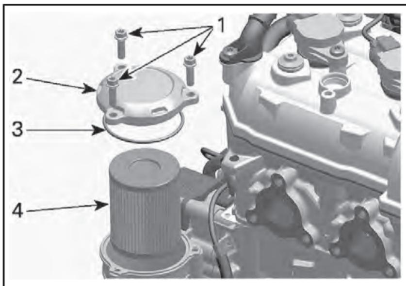
1. Винты крепления крышки масляного фильтра
