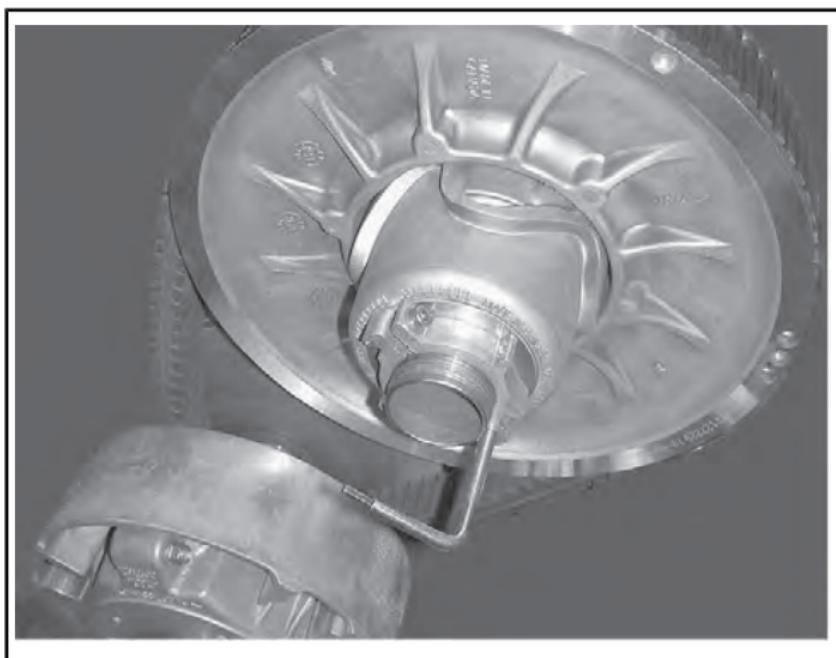
*ТИПОВОЙ ВАРИАНТ — ПРИСПОСОБЛЕНИЕ ДЛЯ РАЗВЕДЕНИЯ ШКИВА ВСТАВЛЕНО В РЕГУЛИРОВОЧНУЮ МУФТУ*
