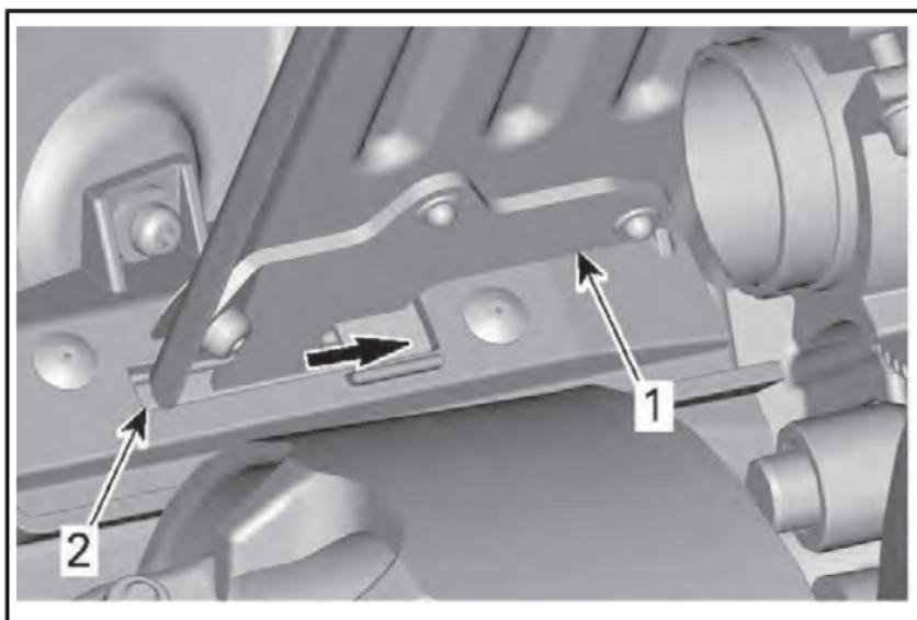
1. Фиксатор кожуха ремня вариатора
