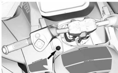
Чтобы обеспечить возможность запуска двигателя, необходимо установить колпачок шнура безопасности на выключатель двигателя.
