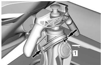
**ТИПОВОЙ ВАРИАНТ - ОТОЖМИТЕ ВПЕРЕД, ЧТОБЫ РАЗБЛОКИРОВАТЬ И СНЯТЬ ПИЛОН**
