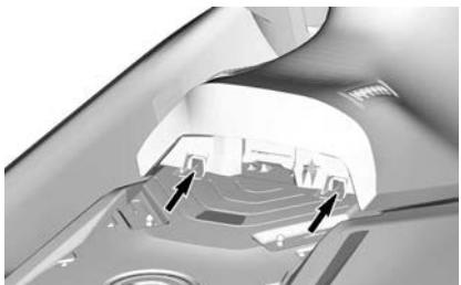
3. Выровняйте фиксаторы заднего конца сиденья с пальцами фиксаторов и осторожно надавите на задний конец сиденья для закрепления на месте.
