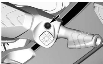
Эта кнопка обеспечивает быстрый доступ к системе BRP Connect. Каждое нажатие переключает представления приложений и функций многофункциональной приборной панели.
