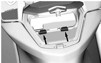
Для защиты телефона от повреждений внутри водонепроницаемого отсека предусмотрен защитный поролон. Убедитесь, что телефон удерживается на месте поролоном, не упирается в края отсека и при этом Вы можете закрыть крышку. Перед использованием удостоверьтесь, что поролон полностью сухой.
