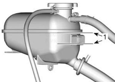
**РАСШИРИТЕЛЬНЫЙ БАЧОК ОХЛАЖДАЮЩЕЙ ЖИДКОСТИ**
