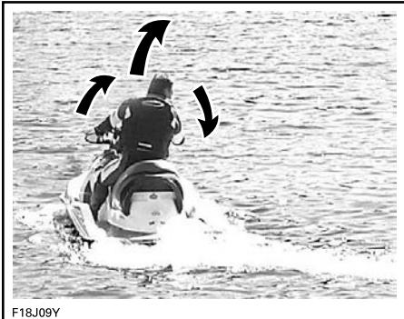
Перекладка руля приводит к повороту сопла водомета в горизонтальной плоскости. Отклоняя руль вправо, Вы будете поворачивать гидроцикл вправо, и наоборот. Чтобы изменить направление движения, необходимо нажимать на рычаг дроссельной заслонки.
