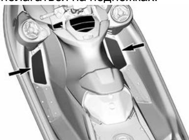
Наклонные подножки для водителя являются уникальными для данного гидроцикла и позволяют фиксировать тело при прохождении крутых поворотов.
