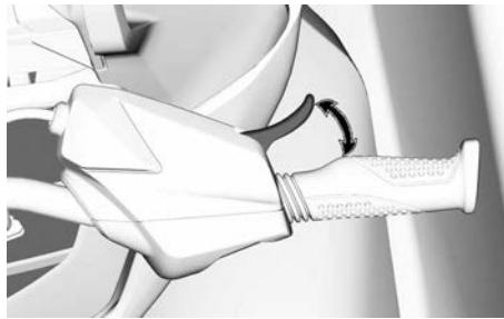
Рычаг дроссельной заслонки подпружинен и при отпускании должен возвращаться в исходное положение, соответствующее оборотам холостого хода.
