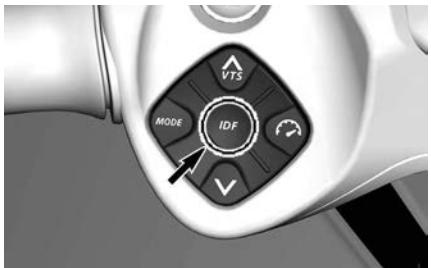
Позволяет активировать систему iDF. См. главу *Использование интеллектуальной системы очистки водометного движителя* в разделе *Инструкций по эксплуатации*.
